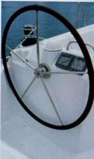
A sinistra, una delle due ruote rivestite in pelle con a portata di mano il winch delle scotte del genoa. A destra, la tuga larga e molto lunga offre ampie zone prendisole, particolari i quattro tientibene in acciaio inox che agevolano il passaggio verso prua.
