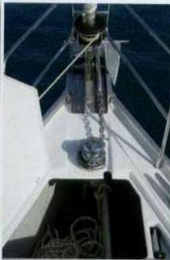
Sopra, il pozzo della catena con il salpancora elettrico posizionato a prua del portello. A sinistra, una vista dei passavanti, abbastanza ampi e liberi da intralci. Buona la tenuta dell'antisdrucchio a punta di diamante.
