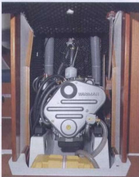
Sopra, l'accesso frontale del vano motore di facile accesso, discutibile come sempre la posizione della batteria in sentina.
